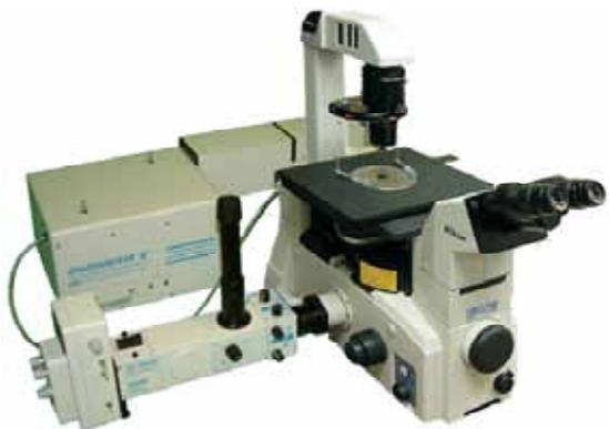
**RatioMaster™**系列荧光比率测量系统，由于采用了先进的DeltaRAM™ / DeltaScan™ 等照明技术，并采用具有超高灵敏度，超高速度的光电倍增管(PMT)作为检测器，极大提高了比率成像的速度，对于双激发单发射，探测速率可达250比率/秒，最高可达650比率/秒；对于单激发双发射，探测速率可达1比率/秒，最高可达1000 比率/ 秒；对于单激发单发射，探测速率可达1000 点/秒。在实验中采用Fura-2, Indo-1, MgFura, BCECF 等荧光探针，可对活细胞内钙、镁、钠离子和PH 值进行测量。通过扩展和升级，可实现
