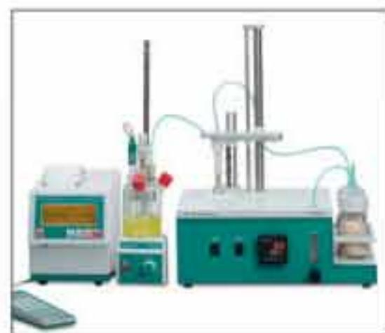
卡氏样品加热炉具有实验重复性好、无副反应干扰、无样品污染等优点，适用于对困难样品进行预处理。图中显示的是手动加样的832卡氏样品加热处理器。
