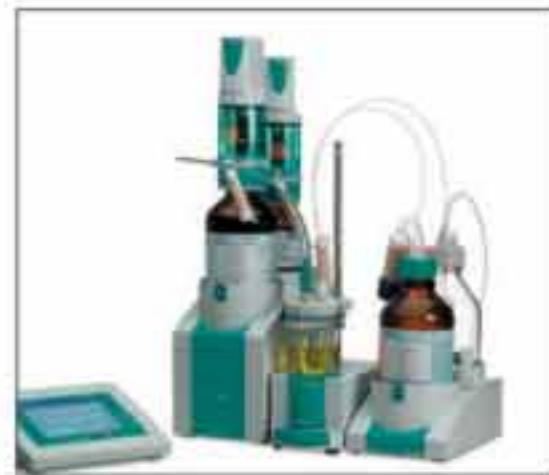
841智能型卡氏水份测定仪是高端的容量法水份测定仪，适用于含水量较大的样品。841拥有电脑或触摸屏控制模式，使用800瓶定配液器，tiamo操作软件，不仅可以测定水份，还可以测定pH值、温度、电位，并进行设定终点滴定。
