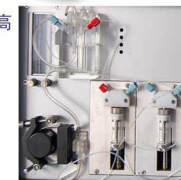
LUMINA 3400 流动注射 进样系统，双注射泵处理 样品与还原剂
