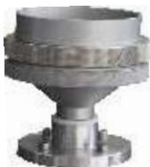
与喷嘴相连接的滤膜托(直径102mm)
