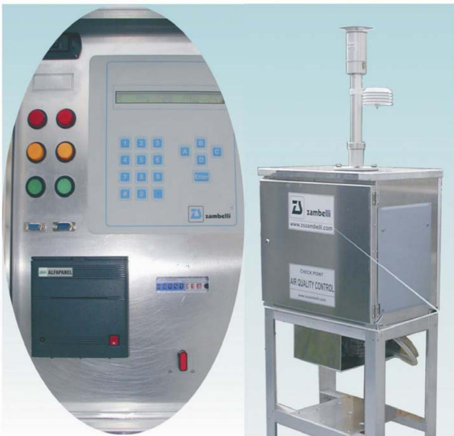
赞贝利有限公司提议建立一种新型顺序标准紧致系统，用于细尘采样：PM10、PM2.5 和PM1用于测定某封闭区、市区或郊区的环境影响。该系统柜完全绝缘，带风扇，并具有热变电阻和空气调节器或标准版Peltier（模块集成温度控制器）。
