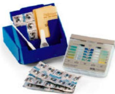
壤 N/P 检测模块用于对硝酸盐氮和磷酸盐的检测，而对于钾的含量则采用了基于比浊法的特殊双试管组件进行检测。该套件为铝制加固便携箱包装，内含有可完成 50 次土壤 N、P、K 的检测所需的足量提取剂和试剂片。
