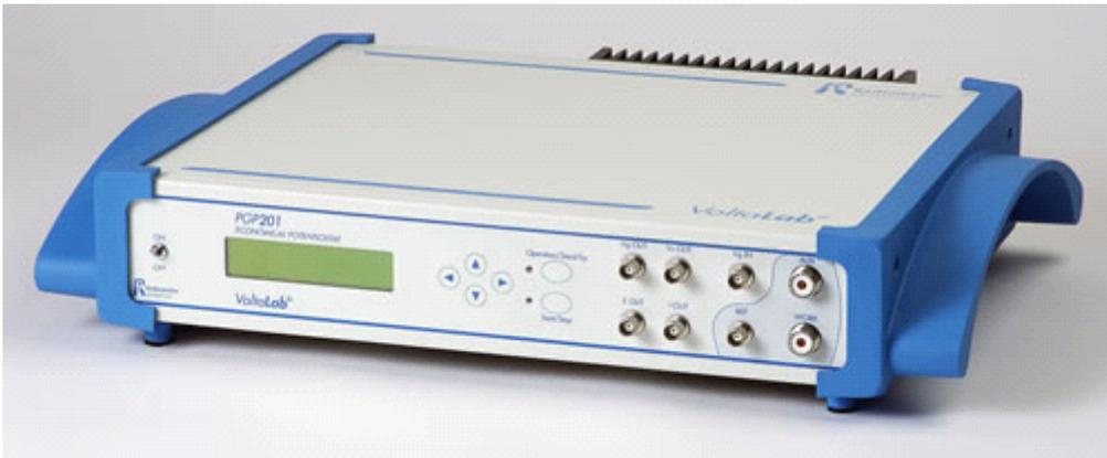
VoltaLab 21 经济紧凑型恒电位/恒电流仪，内置信号发生器，当使用前面的控制面板的时候，可以作为独立的仪器使用。在这种手动模式下，这台 PGP201（指主机）的扫描速率可以选择到高达2.5 V/s，使用 VoltaMaster 4（软件通过电脑控制时），最大扫描速率是10 mV/s.，是腐蚀研究的非常理想的仪器，VoltaLab 21可以记录非常长时间的极化阻抗和腐蚀电势，可以提供点（腐）蚀测定与电偶合腐蚀测定方法。VoltaLab 21 可以在漂移和不漂移的工作模式。
