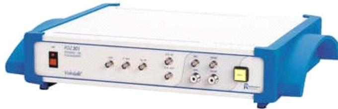
VoltaLab 40 是一款功能显著、操作简易的恒电位仪。它通过提供动态补偿在阻抗测量的欧姆降补偿方面取得重大突破，可作为高水平研究用仪器。作为目前市场上一体化设计的恒电位仪，VoltaLab 40 操作简易、功能强大，是一款理想的电化学阻抗分析和伏安技术实验的电化学仪器。
