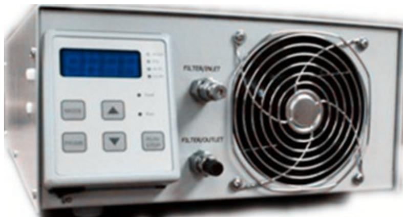
Model SFC-24 是一款可靠、准确、优重现性的CO<sub>2</sub> 输液泵，专为超临界及其它用途设计。Model SFC-24 的流速最大可达24mL/min，最大压力为10000psi。该泵恒压模式下可选择压力设定点，流速可自动调整以满足设定的压力。
