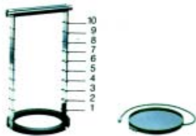
图 17 十层搁板支架 +带温度传感器的搁板
