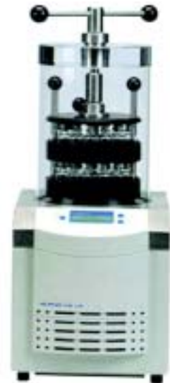
图3 带2层搁板 (φ 200mm) 的密封压盖冻干系统
