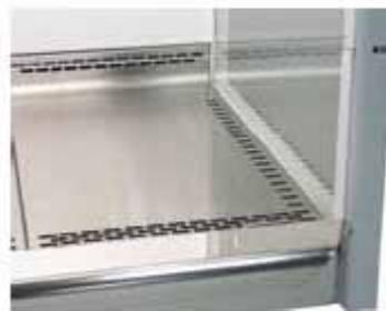
安全柜操作室两侧侧壁前端的一排吸气孔可以将安全柜边缘的气流吸入，避免死角空气。
