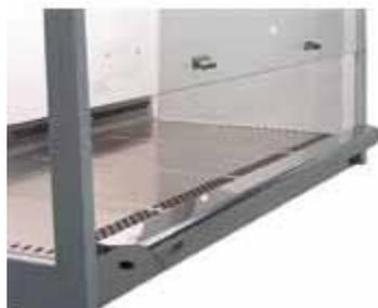
前玻璃窗的升降利用物理学上的抗平衡原理，内置气垫弹簧，操作人员无需费力就可以自由升降；
