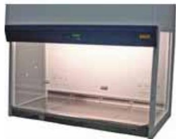
标准操作台是多块不锈钢。每块不锈钢都是经过合理设计，圆滑无清洁“死角”区；每块都有“提手”可以方便将喷洒液体倒入排水槽。
