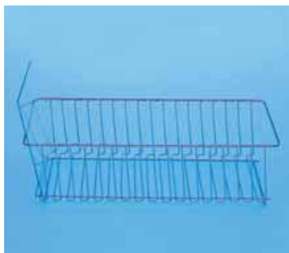
SL18 标准200x200mm色谱板材支架. 为色谱板材设计. 容量18个项目. 支架有特别的形状, 放置点会在板材表面之外.
