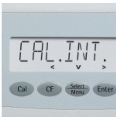
BSA-CW 所有型号都标配内置电机驱动的校准砝码，最大限度确保称量精度和操作便捷性。
