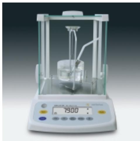
密度直读功能，直接显示测得的密度。
