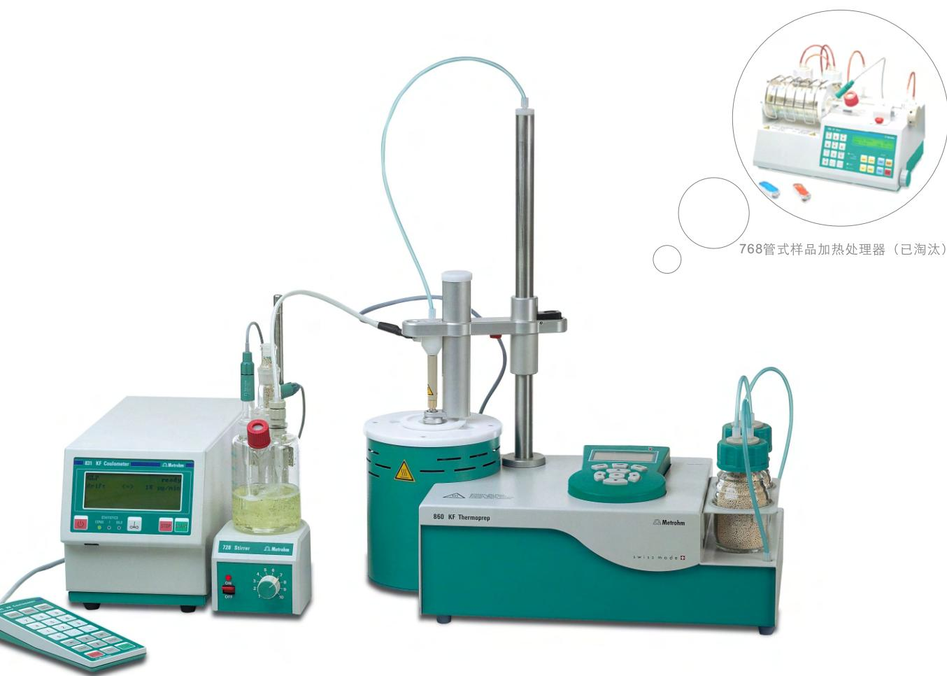
卡尔费休法分为库仑法与容量法。与容量法不同，库仑法卡氏反应中的碘直接由发生电极电解产生，再利用电解碘所需的电量与碘之间的定量关系计算出样品的含水量。卡氏库仑法是绝对测定，无需测定滴定度。
