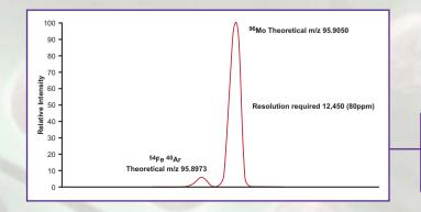
高分辨率: 分辨率RP=10,000下的扫描图。<sup>96</sup>Mo的 同位素峰和其相邻的干扰峰<sup>56</sup>Fe<sup>40</sup>Ar(源 于Ar气)相区分开。
