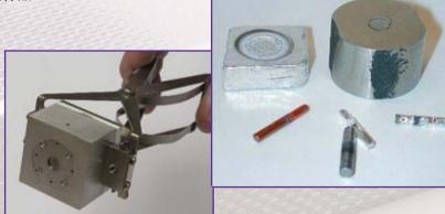
可以分析块状和棒状的固体金 属样品。使用射频离子源可进 行非导体样品分析。
