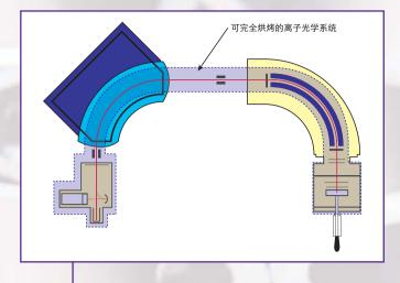
离子光学系统烘烤: 飞行路径(蓝色部分)可以完全烘烤,使 污染程度维持在最低水平,仪器性能保持 在最高水平。
