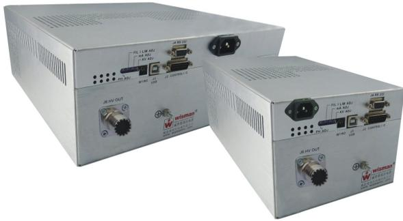
威思曼MRD系列是模块式高稳定精密高压电源。MRD系列模块电源具有良好的调节性能，并且提供正高压或负高压输出，MRD系列模块电源可以内、外、计算机精密测控，可选USB2.0和RS-422数字控制接口。MRD系列模块电源保护有过压、过流、拉弧、安全互锁等。
