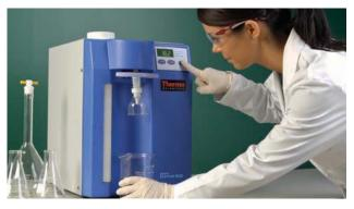
高能见度显示屏幕,提供水通过0.2µm 最后过滤器前的准确电阻率数值.
