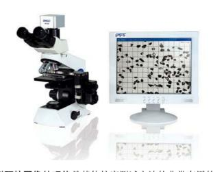
PIP9. 0 型颗粒图像处理仪是其他粒度测试方法的非常有用的辅助工具,是我国现行金刚石微粉粒度测量标准的推荐仪器,PIP9.0 型比 PIP8.1 型最主要的进步是实现了自动调焦、自动扫描视场等功能。
