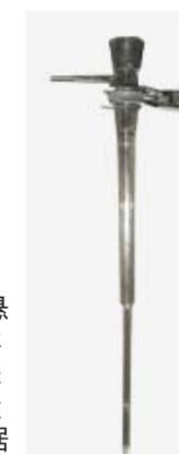
石英腐蚀套件
