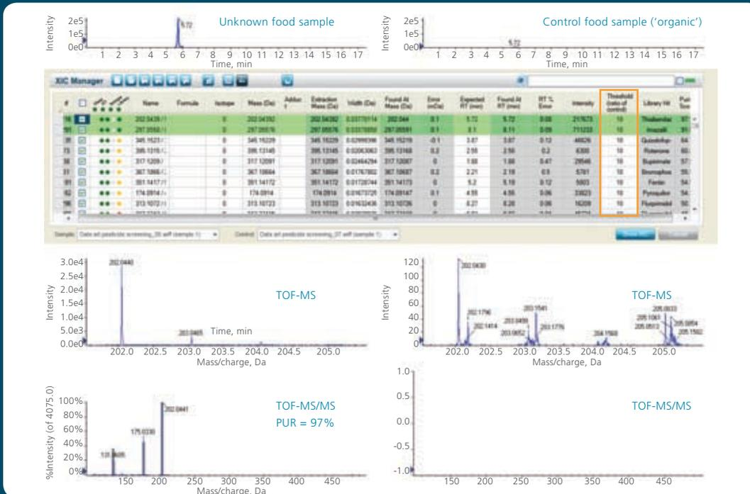
TripleTOF™ 4600系统质谱可以非常方便地对食品和环境样品中的未知化学污染物进行分析，在一次进样中既可以进行目标化合物分析，也可以进行未知化合物筛查。通过准确测定的化合物TOF-MS和TOF-MS/MS谱图进行谱库检索。
