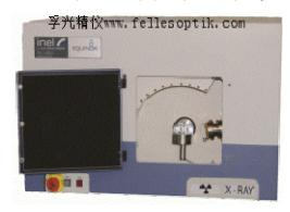
这款微型 X 射线衍射仪是 21 世纪革命性的创新成果。 该微型 X 射线衍射仪结构紧凑,融入大型 X 射线衍射仪的各种功能而具有超低的价格。该微型 X 射线衍射仪采用独特的具有专利技术的曲线弧型探测器代替传统的机械扫描测角仪器,从而实现实时高速测量。该小型 X 射线衍射仪所使用的曲线弧型探测器可以同时测量所有的衍射峰值,并且彻底摆脱了机械扫描的测角仪器。
