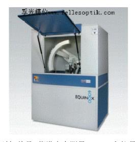
粉末 X 射线衍射仪具有 X 射线衍射, 单晶, 薄膜应力测量, SWAXS 和拉曼以及 EDXRF 测量等多用途多功能高级粉末 X 射线衍射仪, 该产品与其它采用"机械扫描测角仪器"的粉末 X 射线衍射仪不同,它采用独特的具有专利技术的曲线弧型探测器代替传统的机械扫描测角仪器,从而实现以超高分辨率超高速度实时完成2theta的测量。
