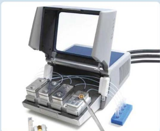
1. 将传感器放入控温样品池内，四个传感器被固定在具有进口和出口的可拆卸流动池中。石英晶体传感器预先采用金属、高分子或其他预吸附层等进行表面修饰。
