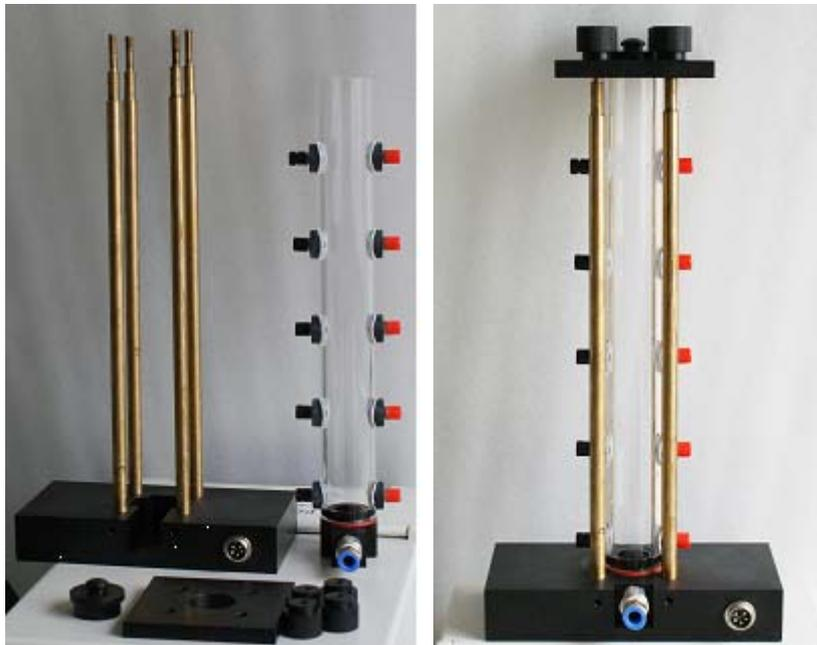
最后要把样品管组合平台放入观察箱体，并连接上导线。接上气管，如需加热则还要接上控温线。
