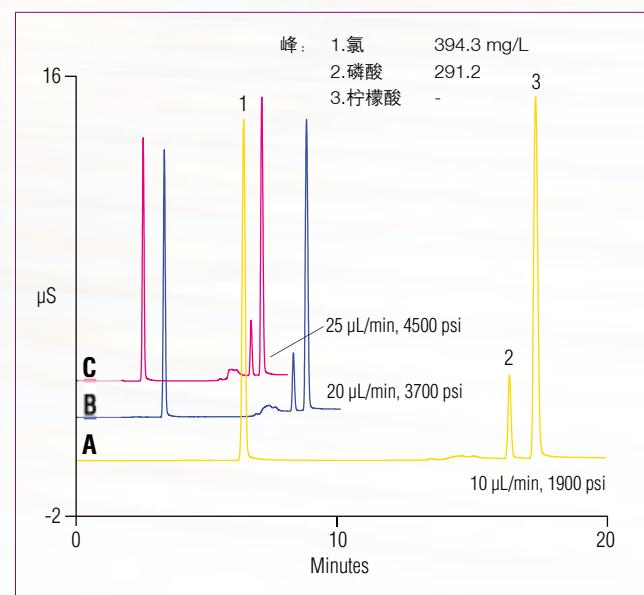
可使用HPIC高压毛细管离子色谱系统，实现对无机阴离子的快速分离（配备Dionex IonPac AS18-4μm, 0.4 × 150 mm色谱柱）
