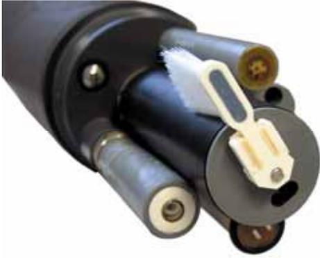
YSI 6820EDS 传感器（从底部开始，沿顺时针方向）快速脉冲溶解氧、酸碱度、浊度、铵氮、温度/电导率。所有探头（电导率除外）在清洁刷的维护下均不受沾污。
