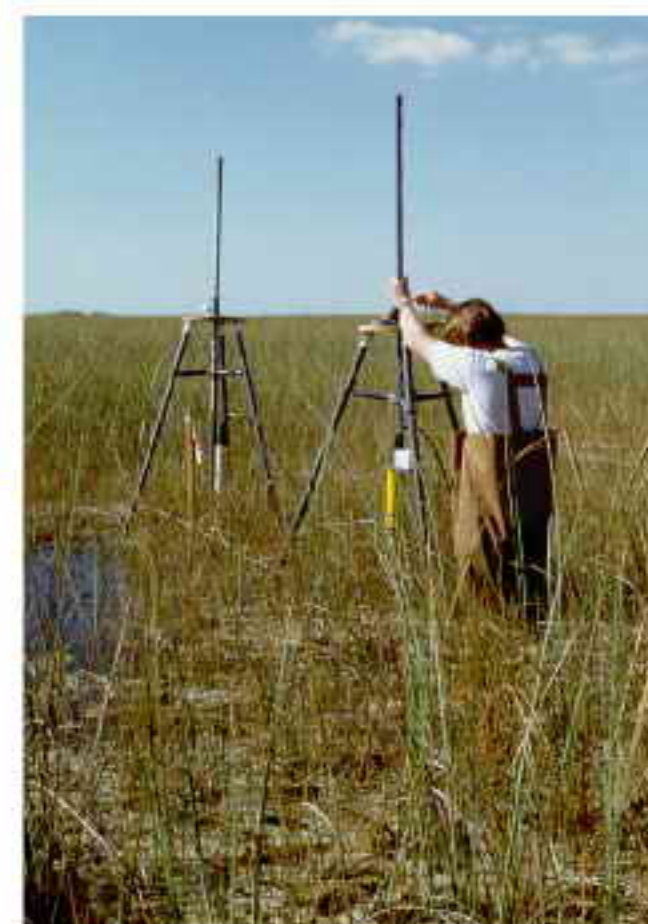
美国地调局 (USGS) 采用 ADV 测量沼泽地中的流速
