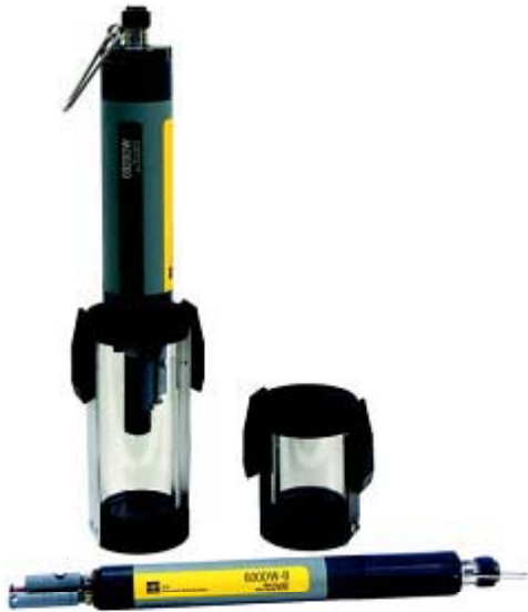
YSI 6920DW/600DW 型饮用水多参数安全监测仪 与 配套使用的流动室
