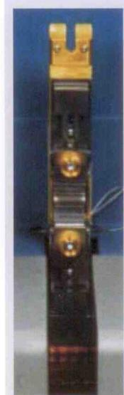
横向加热确保样品完全原子化，石墨管两侧翼具有高质量，可为样品提供最高的导热系数，并具最高的加热均匀性。
