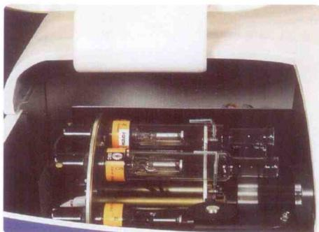
8灯座自动识别、自动转换和预热，自动调整光学位置，两位面自动优化保证最大的光通量。自动多元素操作。可采用标准空心阴极灯和超灯。
