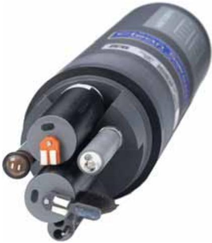
YSI 6600EDS 传感器 (从底部开始, 沿顺时针方向): 温度/电导率、浊度、快速脉冲溶解氧、叶绿素和酸碱度/氧化还原电位。所有探头 (电导率除外) 在清洁扫的维护下均不受沾污。
