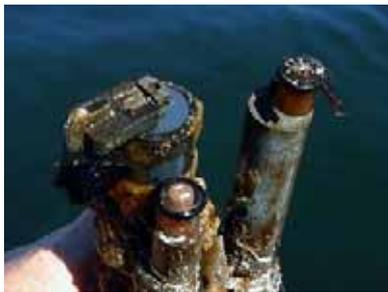
2001 年, 在马萨诸塞州巴泽兹湾中连续投放 80 天后的 YSI 6600EDS 测试用初型。位于最前面的是干净、依然能够工作的溶解氧探头, 右上方是被用作比较的一个没有清洁扫维护的探头。请注意, 没有清洁扫维护的探头上覆盖了厚厚的一层动植物。
