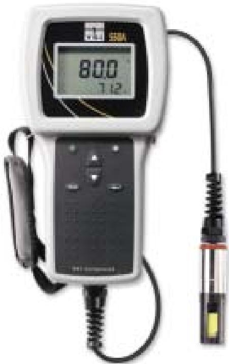
YSI 550A 采用全水密（IP67 防水等级）、防撞击仪器外壳，并启用创新性可于野外更换的溶解氧电极模块。使用 YSI 久经考验的极谱法技术和 YSI 全球高精密度温度典范的热敏电阻法技术，可同时测量溶解氧和温度。新一代 PE 盖膜提供更快的反应时间和更低的搅拌依赖性。
