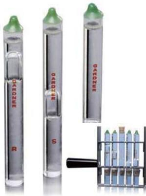
标准：ASTM D1131 D1545 D1725 AOC方法 Ka 6-63 FTMS 141-a，方法4271
