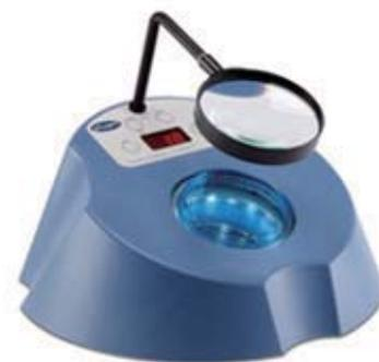
SC6 专为菌落快速准确的计数而设计。其操作简单，只需将培养皿放置在压力感应垫上、用尖式触笔按顺序点压即可。通过点压传导转化成数字形式显示在LCD屏幕上，并发音响应计数。尖式触笔能避免漏计或重复计数。压力感应垫的触压可以调节以适应使用者。
