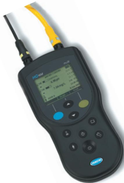
單埠或雙埠主機連接IntelliCAL 智慧型探棒，自動辨識水質項目及校正歷史。雙埠主機支援兩個量測頻道，同時顯示兩種測值。檢測項目包括pH、導電度(鹽度、TDS、電阻率)、ORP、溫度、溶氧、氯離子、氨、硝酸鹽、氟離子及鈉離子。
