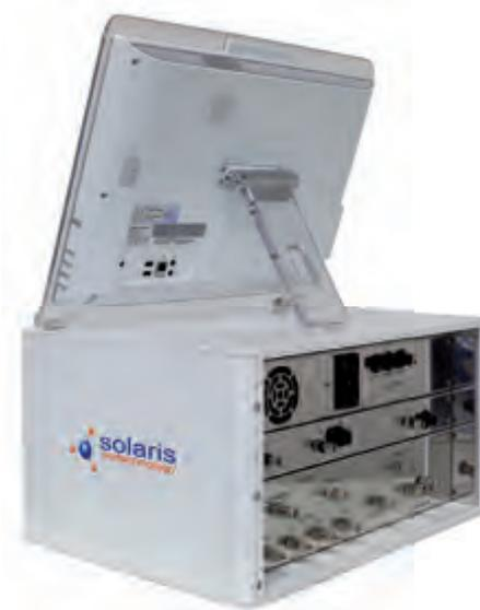
6 紧凑型控制器。电源100-240V,3层抽屉式可移动模块设计理念,让售后服务更方便。
