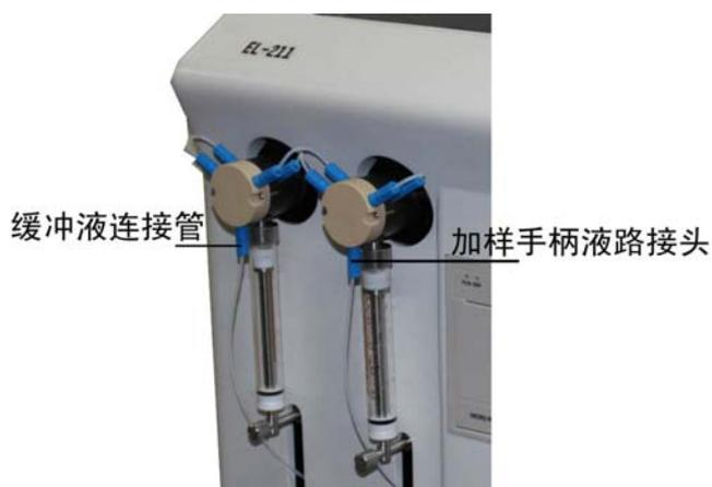
(缓冲液连接管、加样手柄液路接头-连接图)
