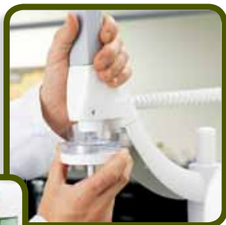
更换Millipak 终端精制器
