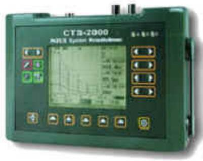
CTS-2000 PLUS 在我单位与德国 Krautkramer 公司合作开发 CTS-2000 基础上,对系统软、硬件进行全面升级,它是国内新一代体积最小、重量最轻的笔记本式数字超声探伤仪。具有采样速率高、存储容量大、功能齐全、技术先进、携带方便、易学易用等特点。最适用于流动性大和高架空的探伤作业,也可广泛用于机械制造、航天航空、交通、石化、能源等部门的钢板焊缝及锻件的超声探伤。
