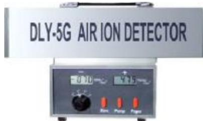
DLY-5G 型空气离子浓度测量仪可用于测量空气本底值及各种空气离子发生器所产生的各种正、负极性的大、中、小离子。具有测量准确，灵敏度高、抗潮能力强、使用方便的特点。其收集器采用国际流行的 Wesix 平行板式空气离子收集器；收集器极板经过镀金处理，离子电荷转化效率高，工作稳定、可靠；一组收集器同时收集两种极性的离子，两组液晶显示器同时显示正、负离子的浓度，在测量正、负离子比例时具有特殊的优越性；它还采用了先进的自动调零技术，使仪器操作起来更加方便。同时还设置了特殊的极板驱潮装置，可以确保仪器在湿度特别高的环境中可靠地工作。仪器的供电电源采用大容量锂电池，可由交流市电或汽车电瓶充电。仪器外壳用优质铝合金制成，强度高、重量轻、美观大方、整体性强、便于开展室内、外测试项目。该仪器按国际通行技术规范进行标定，测量原理及测试数据与国际上各先进国家所采用的测量手段一致。便于数据的比较和交换。预计，该仪器特别适合做气象、旅游部门以及在湿度大森林、海滨、江河湖泊地区使用。
