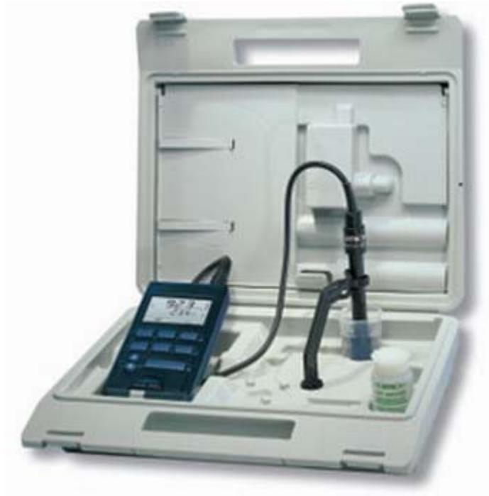
Cond330i 系列手提式电导率测定仪 WTW 通用型电导率测定仪,带大尺寸,多功能 LCD 显示屏,可测试电导率,温度,盐度,TDS.配套 TetraCon 专利 4 极电导电极,耐污染,可提供非常精确的测试结果.
