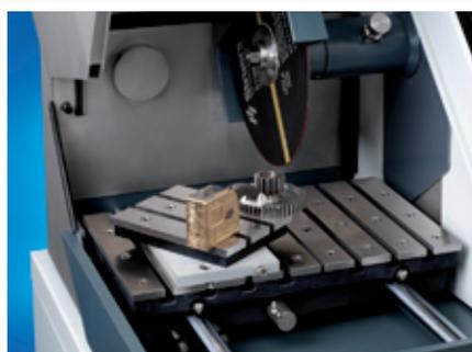
切割工作台提供10毫米T形槽，以便使用各种夹具。
