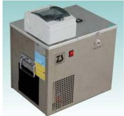
通过温度调节器的冷却水，WM15系统可以保证高效的制冷控制。通过恒温器进行温度设置，还可维持温度恒定。WM15 装配有传感器，可以读出烟气温度。使用循环泵可以冷却保温箱(例如 POLAR - PF 18006) 一旦达到设定的水平线，利用蠕动泵可以进行排放物自动冷凝收集。
