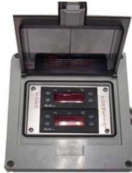
冷凝系统，WM15，用于冲击器采样过程中冷凝和收集
