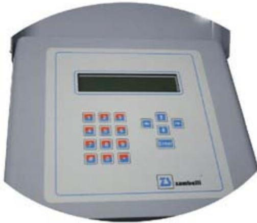
带有 4 行 160 个字符的背光液晶显示屏
