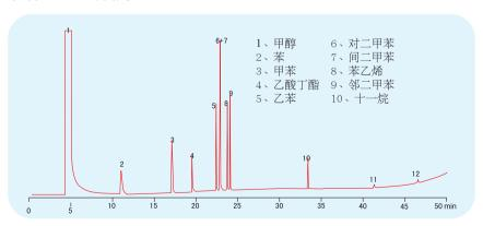
色谱柱型: 50M×0.32mm×1.0μm DM-TV0C 色谱条件: 柱箱温度: 50℃(10min)~250℃,
