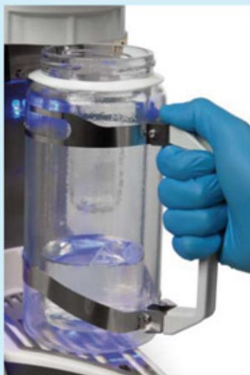
EZ-2配置着Genevac设计的革命性的冷凝器-SpeedTrap。这个新颖、高效的抗溶剂腐蚀冷凝器,用来收集溶剂,既保护了环境,又加快了蒸发速度。SpeedTrap可以达到-50°C,适用于所有的挥发性溶剂。而且,即使是用水为溶剂,也不会发生冰冻。溶剂被收集在一个绝热、耐腐蚀的玻璃瓶中,用户可以观察液面情况,从而决定何时倒空溶剂。这个过程是十分简单的,将玻璃瓶旋转四分之一,取下,直接将溶剂倒入废液槽即可。装上玻璃瓶旋转四分之一,EZ-2就可以再运行了。
