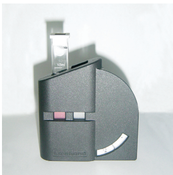
1. 将空白样插入左侧的比色槽
