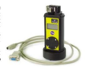
RadonRAE PRO 检测仪可以同计算机连接从而显示实时条件下同位素的分布和累计放射性剂量曲线。NiMH 充电电池提供 50 小时的操作。
