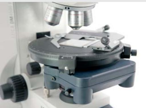
满足最高要求：Leica DM4500 P 的旋转载物台
