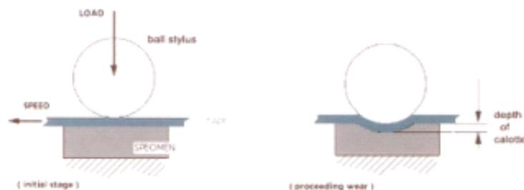
TAPERADER®在进行测试时，测试头以一定的负载对被测试表面进行挤压。对其表面产生轻微损伤，测试时间大约为 60s，然后，TAPERADER®将进行自动的扫描绘制扫描图像。
