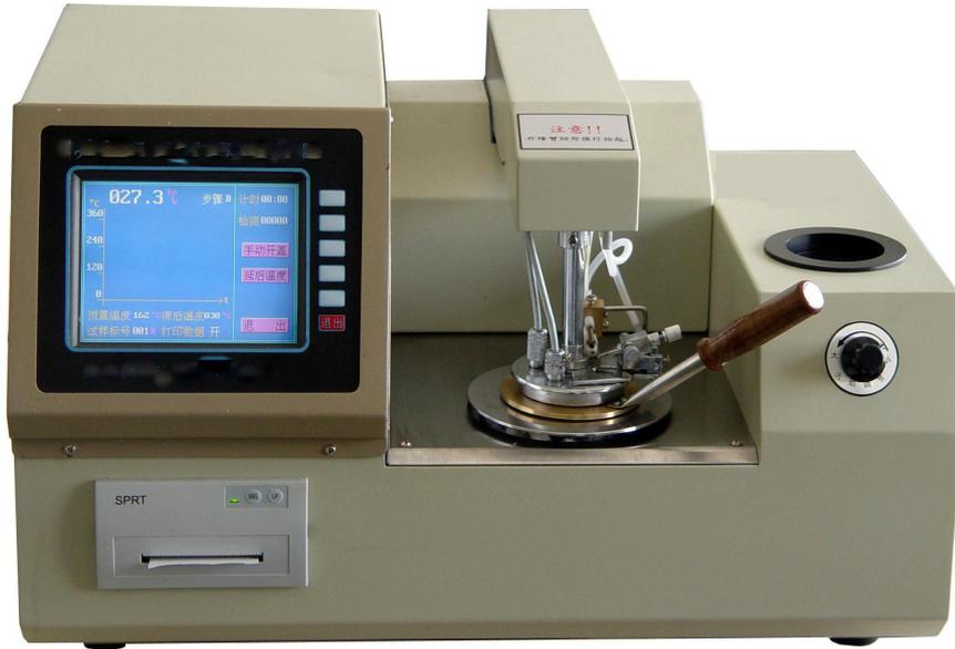
本仪器是按照中华人民共和国行业标准中华人民共和国标准 GB/T261 《石油产品闪点测定法(闭口杯法)》所规定的要求设计制造的。适用于按此标准所规定的方法，测定石油产品用闭口杯、在规定条件下,加热到它的蒸汽与空气的混合气接触火焰发生闪火时的最低温度，即闭口杯法闪点。
