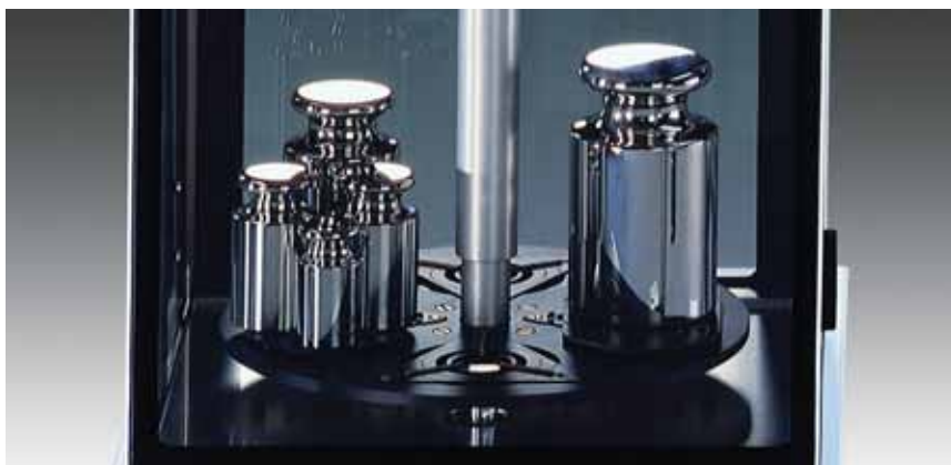
使用 CC1000S-L 比对砝码组的质量基准
