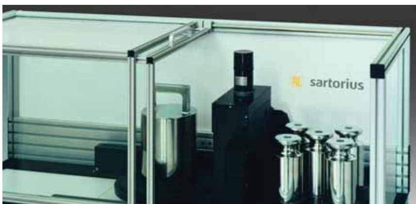
在 CC50001S-L 上用一组质量基准进行砝码比对
